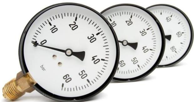
Il Laboratorio MTA s.r.l., grazie alla innovazione LAB DMM e alla preparazione dei nostri tecnici, è in grado di rilasciare rapporti di taratura sulle pressioni fino a 2000 Bar sia in mezzo gassoso che liquido eseguendo una taratura su un ciclo composta da 10 punti sperimentali e 2 punti di ripetibilità.
